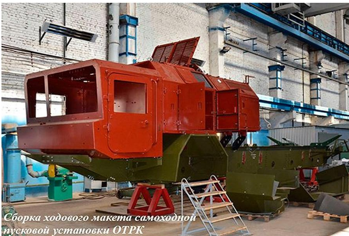
تصویر مونتاژ لانچر سامانه موشکی گروم ۲، انتشار تصویر در ۳۰ آگوست ۲۰۱۶
